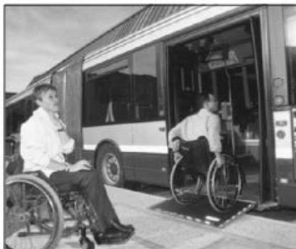
Рисунок 45 – Пример применения механической аппарели автобуса на посадочной площадке в габаритах места посадки инвалидов
